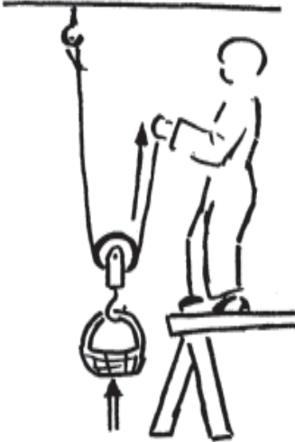
Abb. 9: Hochziehen mit Seil, die Last hängt an einer Seilrolle
