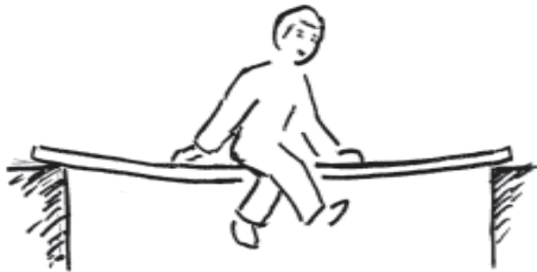
Abb. 4: Ein Balken biegt sich immer unter Last
