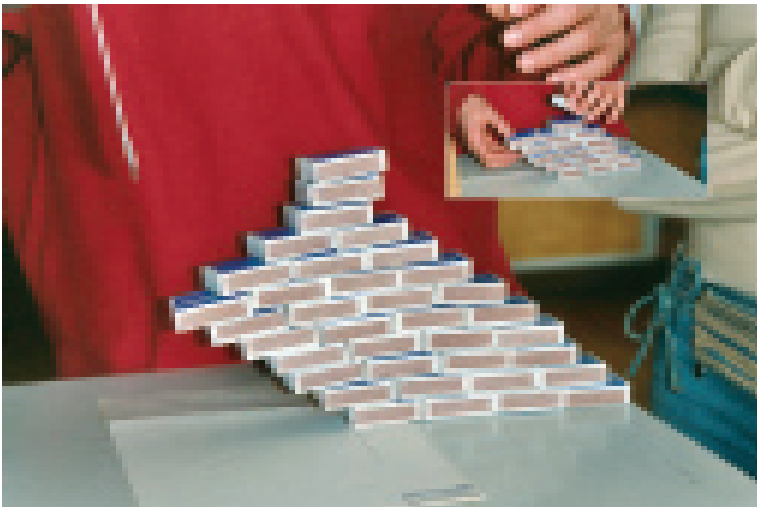
Abb. 2: Ein gelungenes Beispiel für eine überhängende Streichholzschachtelmauer. Die Konstruktion ist offenbar praktisch ausgereizt: An verschiedenen Stellen öffnen sich Risse, der Überhang neigt sich nach unten. Auf kariertem Papier wird der erreichte Überhang vermessen.
